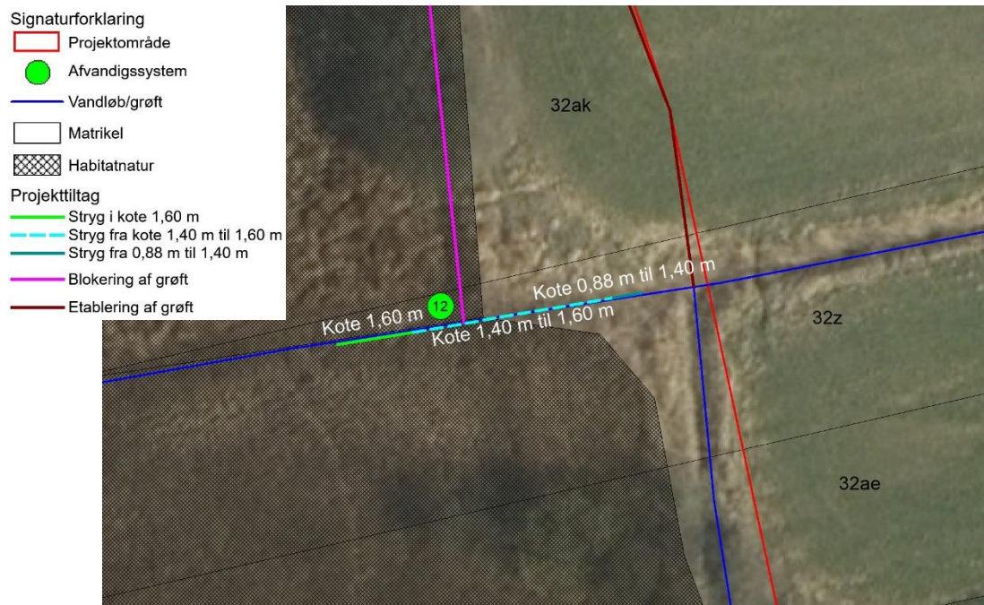
Figur 4: Terrassering af grøft ved opbygning af stryg ved afvandingsystem 12.
