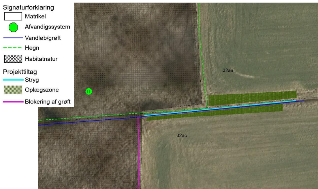
Figur 3: Terrassering af grøft ved opbygning af stryg ved afvandingsystem 11.
